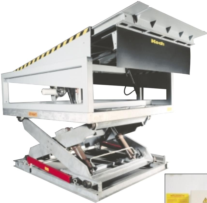
► ermöglicht an einem Tor sowohl normalen Verladebetrieb als auch die Möglichkeit, Hof- und Hallenniveau (horizontal) zu verbinden ► z.B. zur Beförderung von Nutzlasten wie Gabelstapler oder Maschinen zwischen Hof- und Hallenniveau und/oder problemlose Be- und Entladung aller Fahrzeugtypen bis hinunter zum Klein-LKW ► Portalgerüst als Absturzsicherung, entweder feststehend auf dem Hallenboden oder beweglich mit dem Plateau ► Sicherheitslichtschranke im vorderen Bereich
